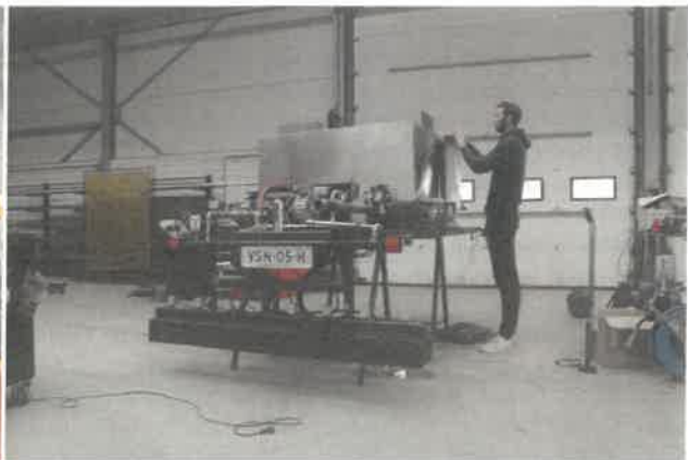
Voor de bitumensproeiwagen van een kleine elektrische asfaltset ontwikkelde GRE zelf een opbouw, die op een elektrische pick-up geplaatst wordt.
