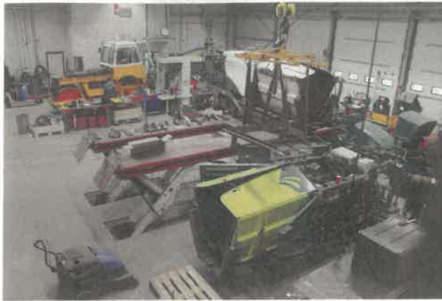
Op de voorgrond een Voegelé 800 die voor Dura Vermeer onder handen is genomen; daarachter eenzelfde Voegelé 800, die nog moet worden aangepakt. Linksachter een Hamm HW90 wals voor Heijmans.
