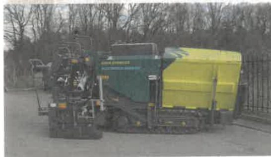
Een gereviseerde en omgebouwde Vögele 1800 asfaltspredmachine. (Foto's: Green Road Equipment)
